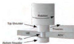
Figure 1. Configuration du soudage FSW avec pion à double épaulement
